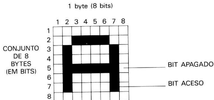
O Arquivo de Imagem contém exatamente 6.144 bytes (ou  $768 * 8$  bits). Como a resolução do vídeo é de 256 X 192, pode-se concluir, então, que cada ponto da tela corresponde a um bit na memória. O bit pode ser ligado ou desligado para compor a imagem desejada.
