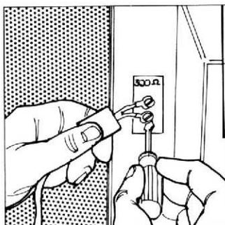
Desconecte a antena da TV e, no lugar dela, instale o CABO de VÍDEO.
