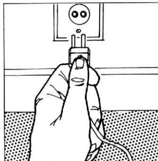
Ligue o plugue do outro fio da Fonte numa tomada AC. Posicione a chave liga/desliga da Fonte de Alimentação em OFF
